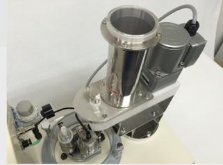
自動ホッパーフィーダーは物質が内部に残らないようにして、ターンテーブルに継続で安定な出回りを提供します。
